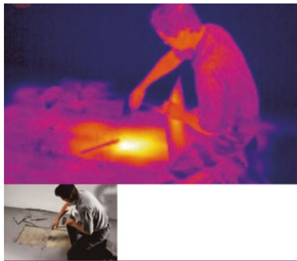
Figura 5. Localización de roturas en tuberías
