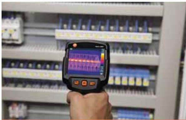
Con carcasa de policarbonato ABS, el equipo presenta grado de protección IP 54, pesa 510 gramos y mide 219 x 96 x 95 mm. Esta herramienta es capaz de hacer mediciones térmicas en un rango de -20 a 280 °C con un nivel de exactitud de  $\pm 2\%$  del valor medido. Asimismo, suma funciones de medición tales como de análisis (punto medio, puntos fríos y calientes y delta T), IFOV warner y testo ScaleAssist. Respecto de la imagen infrarroja, las características son las siguientes:
