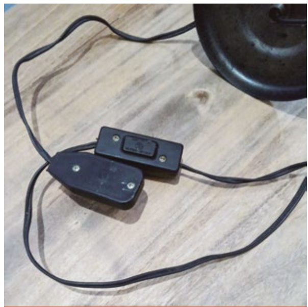
Ficha e interruptor “al vuelo”, cuyos armados rematan en tornillitos metálicos (posible causa de contacto directo)
