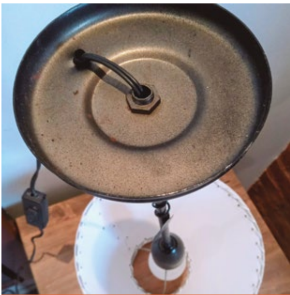
El cablecito pasa por sendos agujeros metálicos con riesgo de cizallamiento parcial (electrificación de todo el velador) o total (cortocircuito y posible incendio).
