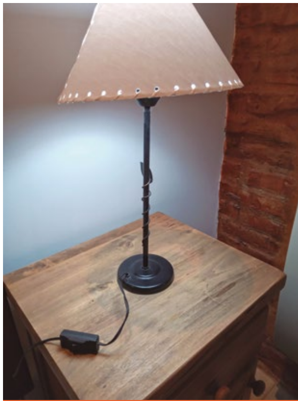
Esbelto velador metálico alimentado con un cablecito bifilar de aislación simple.
