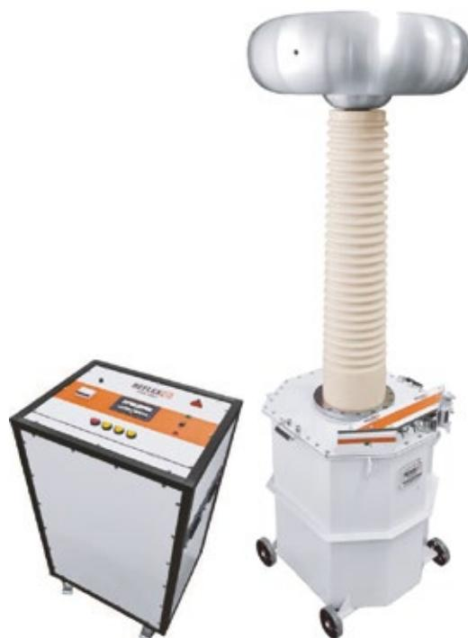
Ensayos dieléctricos de materiales con tensión: si es alta tensión, entonces conviene valerse de un generador de alta tensión con un ajuste variable del voltaje de salida. Eso mismo, precisamente, es el probador RPA 200A, de la marca Reflex, industria argentina.
