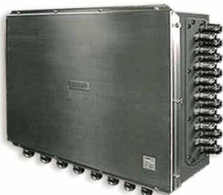
La serie Ex-E de gabinetes de seguridad aumentada se fabrica con caja de acero de 1,6 y 2 mm de espesor, también con acero inoxidable de 1,5 mm de espesor. El grado de protección es IP 65, por lo cual brinda máxima protección a los componentes en exteriores agresivos o corrosivos. La línea cuenta con ocho modelos básicos que se fabrican en tres profundidades estándar: 150, 200 y 250 mm.
