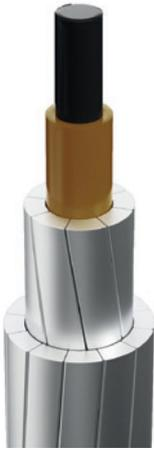
IMALUM HE, cable desnudo unipolar de aluminio con alma de composite de fibras de carbono y vidrio (alta eficiencia), fabricado según la norma ASTM B 857 en un rango de 150 a 1.000 m<sup>2</sup> y temperaturas máximas de operación de hasta 180 °C.
