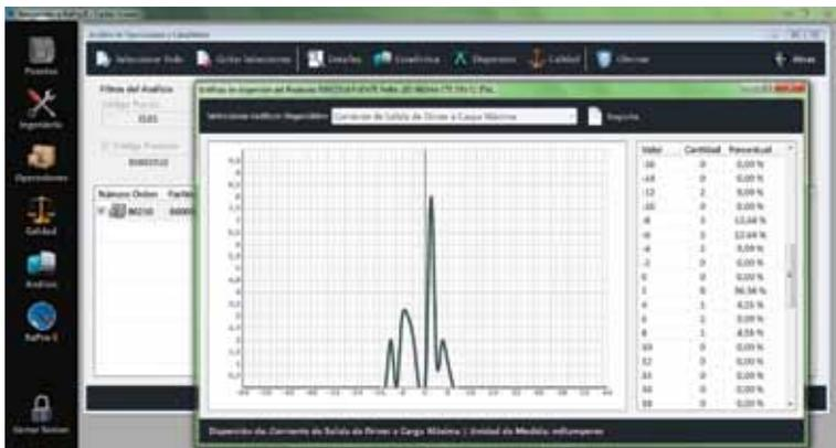
Además del control productivo al cien por ciento (100%) de las unidades, un quince por ciento (15%) pasa por cámaras de prueba de vida durante dos horas bajo condiciones extremas como, por ejemplo, tensión de alimentación anormalmente alta y temperatura ambiente elevada. Este control adicional permite determinar aquellos circuitos donde pueda producirse una muerte prematura de componentes electrónicos.
