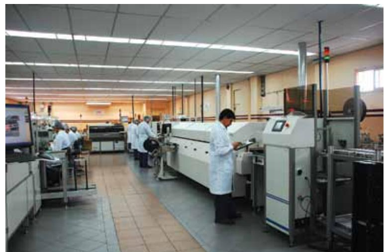
Entre el equipamiento destacado, se encuentran dos máquinas *pick & place* (colocadoras de componentes de montaje superficial), una de las cuales cuenta con cuatro cabezales que trabajan de manera independiente, logrando alcanzar un nivel de productividad de ochenta y cinco mil (85.000) componentes por hora. Solamente esta última ha significado una inversión de cuatrocientos mil dólares (US\$ 400.000).
