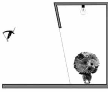
Figura 4. Vista de corte de un cubículo. Se aprecian las ubicaciones del observador, la lámpara y el ramo de flores de papel.
