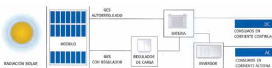
Configuración de los generadores eléctricos solares (GES)
