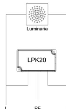
*LPK10* se conecta en paralelo, pero en caso de fallo, la protección se desconecta sin aviso, salvo en caso de tener teleseñalización, se indica en el tablero.
