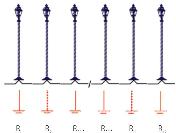
$R_1 = 73 \Omega / R_2 = 87 \Omega / R_3 = 102 \Omega / R_4 = 291 \Omega / R_5 = 276 \Omega / R_6 = 247 \Omega / R_7 = 233 \Omega / R_8 = 218 \Omega / R_9 = 204 \Omega / R_{10} = 189 \Omega / R_{11} = 174 \Omega / R_{12} = 160 \Omega$ . Se determina el valor mínimo  $R_{min}$  de setenta y tres ohms ( $73 \Omega$ ). Se calcula la resistencia eléctrica de puesta a tierra total del neutro para  $V_{N/ta}$  menor o igual a cincuenta volts (50 V):
