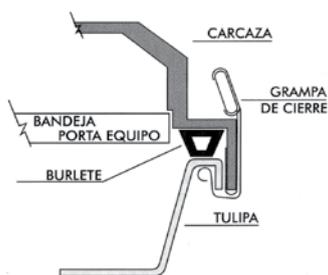
de cierre, de accionamiento manual e impermeables, aseguran el difusor sobre la carcasa y pueden ser de hierro cincado o acero inoxidable AISI 304.
