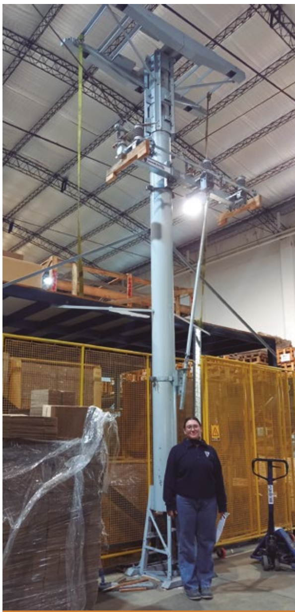
Un poste en tamaño real forma parte del laboratorio de ensayos de Fammie Fami. Los clientes pueden probar tanto el montaje como las operaciones mecánicas casi como en la ubicación real del equipo.
