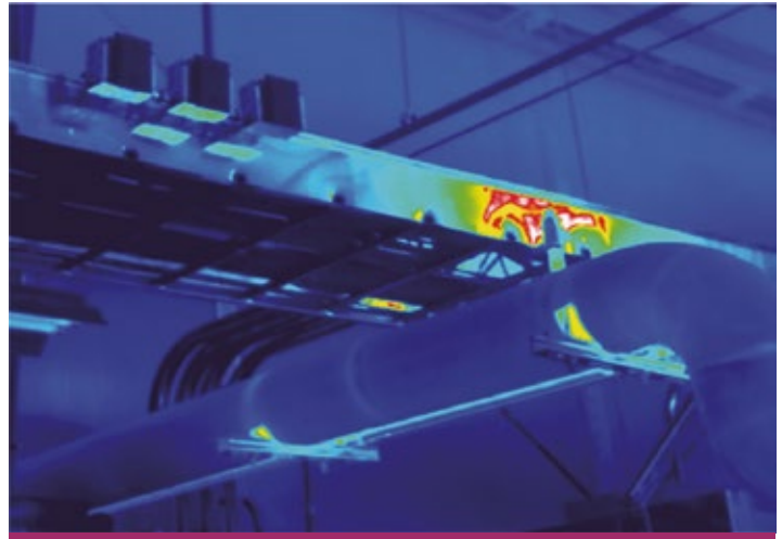
Cojinete sobrecalentado en una cinta transportadora
