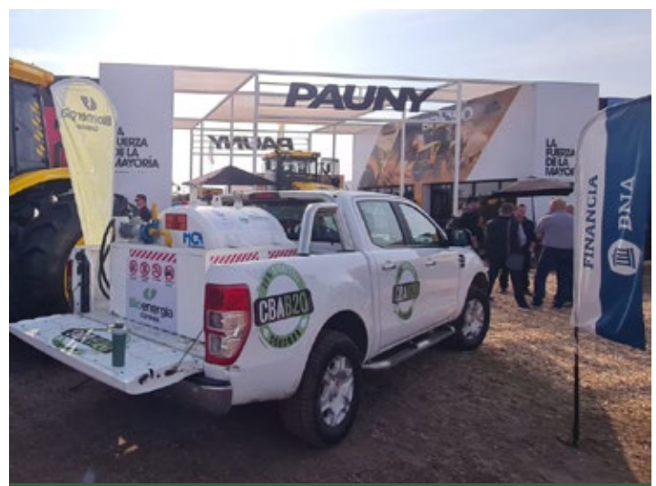
Camioneta, surtidor móvil, para llegar con el bio a un lugar rural alejado
