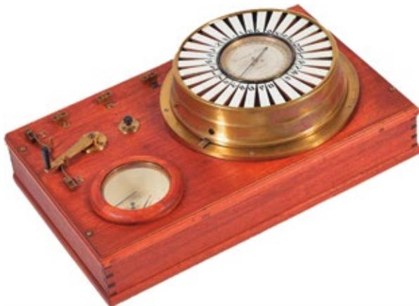
El telégrafo de puntero Siemens, inventado en 1847
