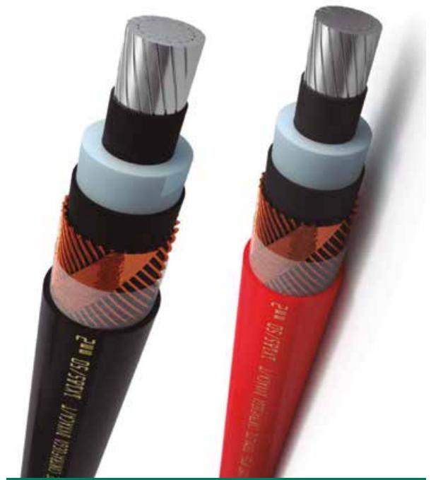
La línea Termolite, de Cimet, de cables de potencia para tensiones nominales de 3,3 (3,6) hasta 33 kV (36 kV) eficaces, se destaca por la aislación con polietileno reticulado (XLPE). Tanto uni- como multipolares se pueden colocar en un amplio rango de aplicaciones, que van desde instalaciones fijas en el interior de edificios civiles e industriales (sobre bandejas, en canaletas, conductos, etc.), hasta la intemperie o en forma subterránea.
