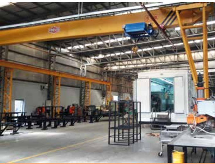
Pórtico de puente grúa, una de las novedades de la planta
