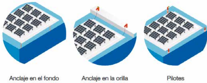
Fondeo y anclajes
