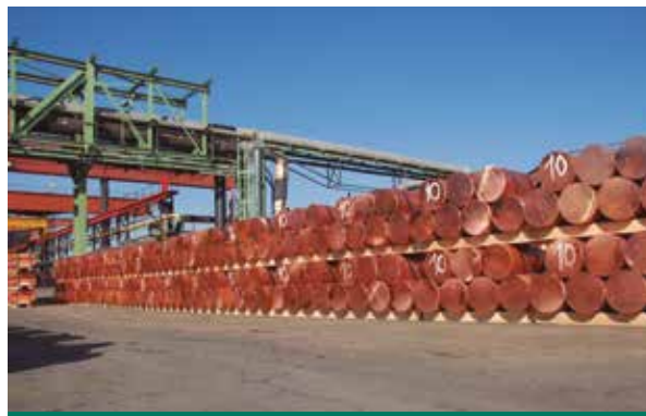
Figura 7. El cobre catódico se vuelve a fundir y se moldea en palanquillas de cobre
