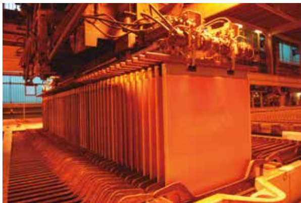
Figura 6. Los cátodos de cobre se cuelgan entre ánodos
