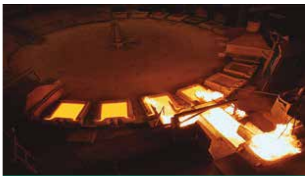
Figura 4. El plato giratorio de fundición del ánodo se mueve lentamente
