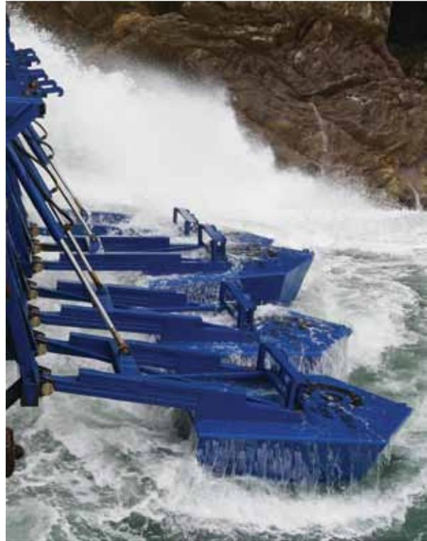
de protección contra tormentas, que previene de los daños a los flotadores. Cuando las olas son demasiado altas para el sistema, los flotadores automáticamente se colocan por encima del nivel del agua y quedan trabados en posición elevada hasta que pase la tormenta. Recién entonces, comenzarán a operar nuevamente.
