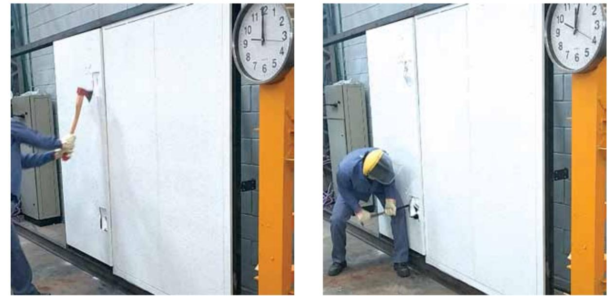
Figura 2 (video). El shelter es sometido a impactos de extrema dureza y los resiste exitosamente
