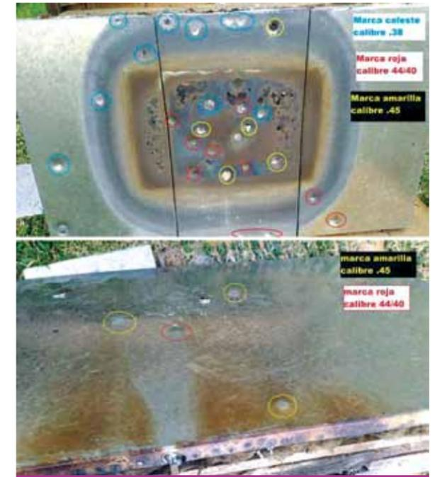
Figura 1. El ensayo balístico fue superado con éxito. Ninguno de los calibres y distancias probados logró atravesar el panel
