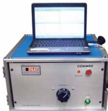
Generador de tensión impulsiva
