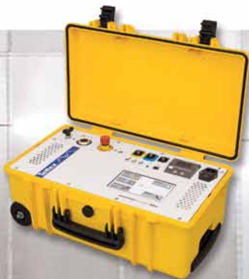
MIDAS Micro 2883 Capacidad y tangente delta con fuente de frecuencia variable hasta 12 kV todo en una única valija
