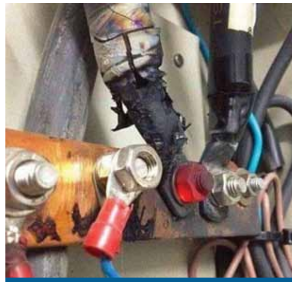
Tuerca al rojo cereza por insuficiente apretado y/o par galvánico cobre-aluminio
