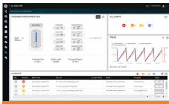
Figura 2. iFIX 6.0 contiene objetos y plantillas diseñadas utilizando las librerías de High Performance HMI
