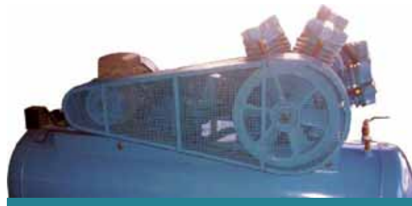
Figura 16. Acoplamiento con poleas y correas
