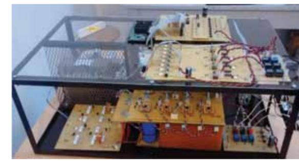
Figura 14. Implementación final del inversor trifásico
