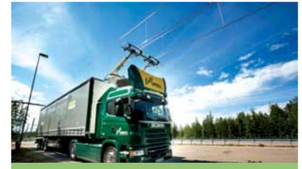
transmisión de corriente estable incluso a altas velocidades. Las líneas de contacto aéreo se alimentan con energía proveniente de subestaciones equipadas con dispositivos de distribución de media tensión, transformadores de potencia, rectificadores e inversores.
