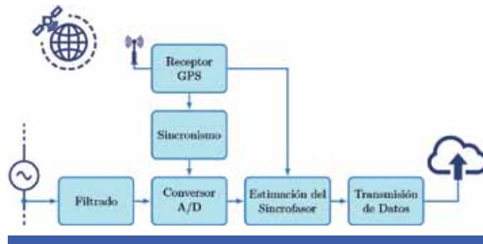
Figura 3. Estructura típica de una unidad PMU
