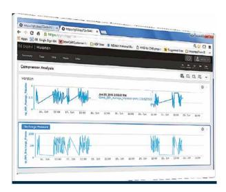
El sistema recopila, archiva y distribuye grandes volúmenes de información de planta a alta velocidad, y los almacena como tags. Especialmente diseñado para la aplicación en industria, opera con valores de proceso como pueden ser temperatura, presión o caudal.
