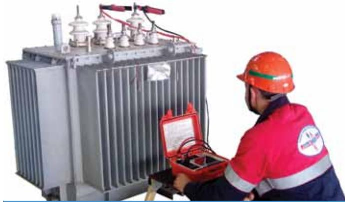
Por último, la medición directa de la resistencia eléctrica de los devanados de fase conectados como "estrella con neutro aislado", lo que conduce a la eliminación de todo el procedimiento de medición de las resistencias lineales y su posterior conversión en valores de fase.
