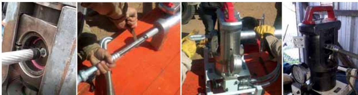
Figura 5. Proceso de compresión de las grapas
