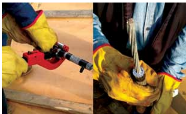
Figura 13. Herramienta correcta para remover las capas del aluminio
