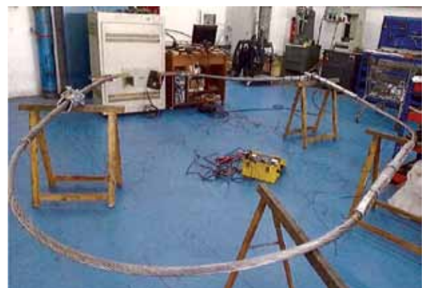
Figura 7. Ensayo de calentamiento o compatibilidad térmica. Se aprecia que las temperaturas de los accesorios no superan los noventa grados (90 °C) cuando el conductor trabaja en alta temperatura
