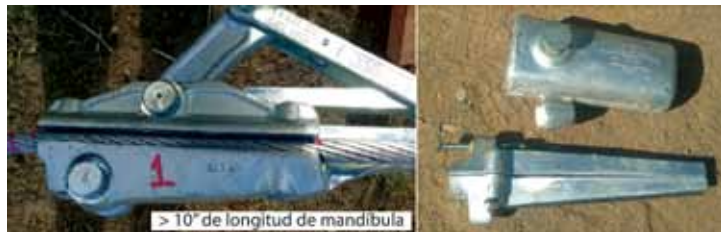
Figura 15. Las ranas recomendadas para conductores ACSS (Izq: tipo chicago; der: tipo cuña)
