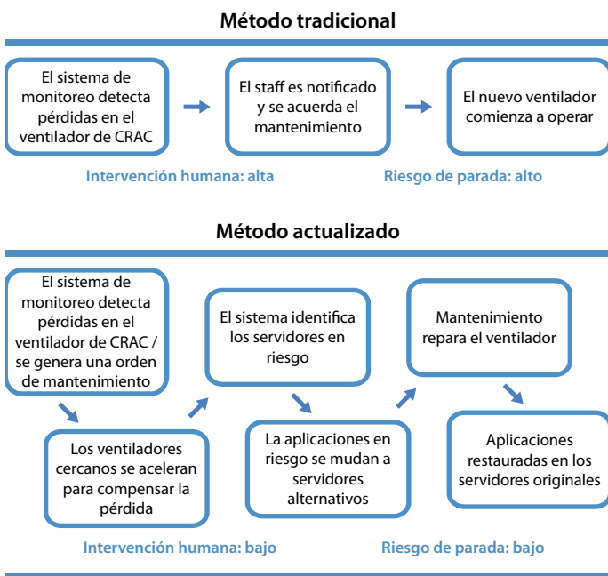
Figura 5. Método tradicional y método moderno: pérdida de un ventilador de CRAC
