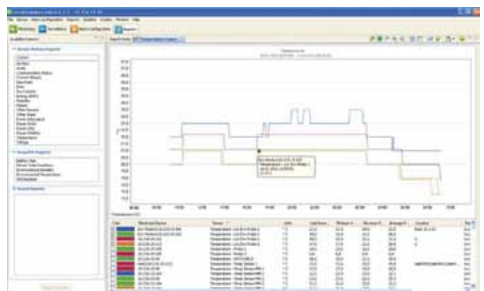
Figura 3. Las herramientas de planificación se pueden usar para analizar el impacto de los movimientos y los cambios sobre la refrigeración y la alimentación del centro de datos (pantalla de muestra extraída de la aplicación APC de Schneider Electric )
