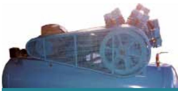
Figura 16. Acoplamiento con poleas y correas
