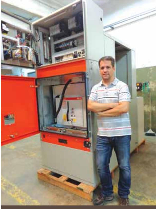
*primarias del tipo Metalclad de seguridad aumentada y poseen interruptores extraíbles WL-r.*
