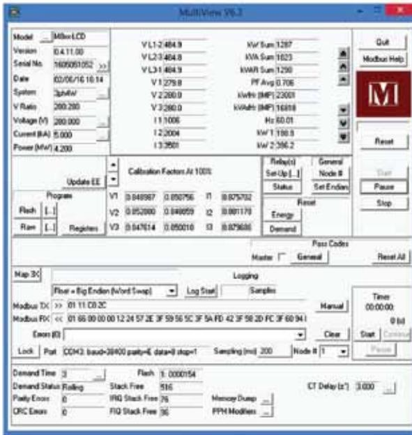
El software de parametrización y visualización *MultiView* se suministra sin cargo y permite, entre otras cosas, visualizar los cuarenta parámetros medidos, las relaciones de transformación de los transformadores de medida, los tiempos de demanda, etcétera que se programan. Permite también
