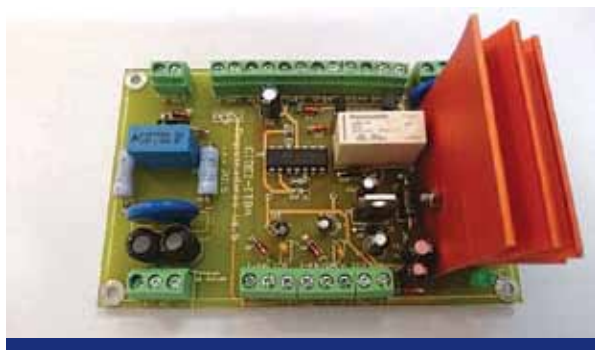
Figura 12. Circuito impreso que contiene la etapa tres
