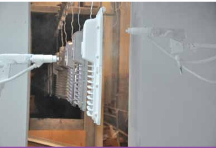
El producto utilizado se aplica a temperatura ambiente por aspersión en una cámara semiabierta, no es contaminante, no produce barros, es totalmente biodegradable y no es necesario tratarlo como efluente. Obviamente se siguen utilizando en otras empresas mordientes de vieja tecnología
