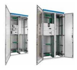
Altura de dos mil milímetros (2.000 mm), anchos de ochocientos, mil y mil doscientos milímetros (800, 1.000 y 1.200 mm) y profundidades de seiscientos y ochocientos milímetros (600 y 800 mm). Compartimentación interna hasta 4b; zona de salida de cable con ancho de cuatrocientos veinticinco y seiscientos milímetros (425 y 600 mm). Grado de estanqueidad IP 31 (con rejillas) o IP 55 (versión estanca).
