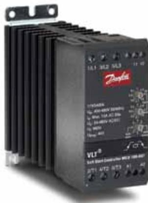
En caso de que no se desee arranque directo en línea, existe el MCD 200 (versiones para 200 a 575 V CA, 7,5 a 110 kW, máximo 200 A), una alternativa a los arrancadores de estrella/triángulo. Cuenta con rampas de tensión o arranque suave en rampa de intensidad limitada, protección integrada del motor, diseño compacto con sistema de bypass interno para minimizar las pérdidas de potencia y módulos adicionales para funcionamiento remoto y comunicación en serie.
