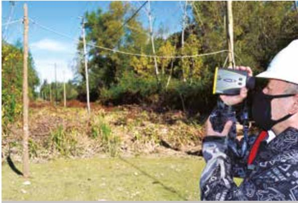
*Easy Target es una herramienta óptima para determinar la altura de los tendidos eléctricos a largas distancias, así como de árboles, antenas, edificaciones, o cualquier otra estructura presente en el terreno.*
