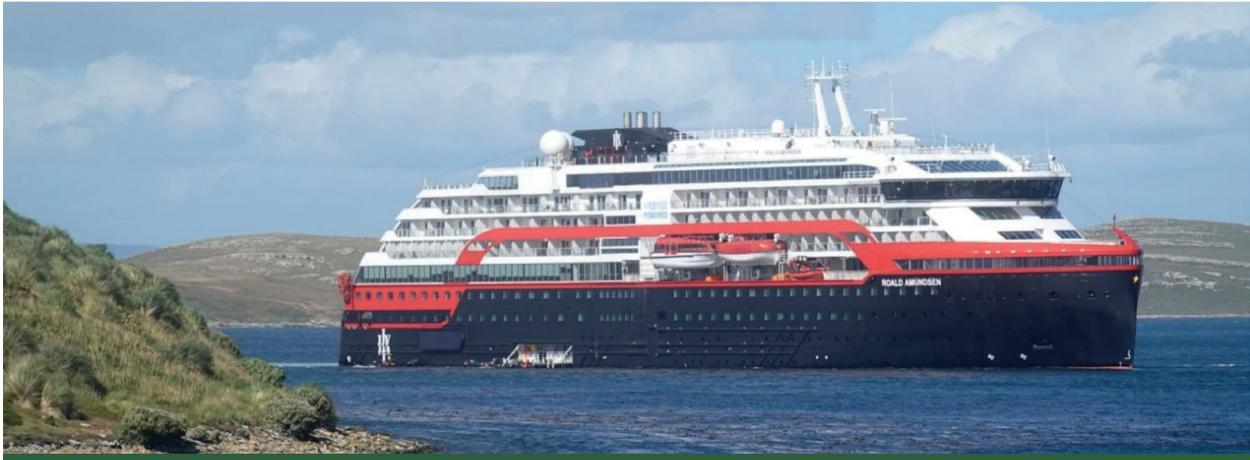
Figura 1. El buque MS Roald Amundsen “fondeado” en la rada de entrada del paraje West Point, muy cercano a la isla Gran Malvina. (Para mantener su posición, este buque no usa sus anclas, sino su sistema de posicionamiento dinámico).
