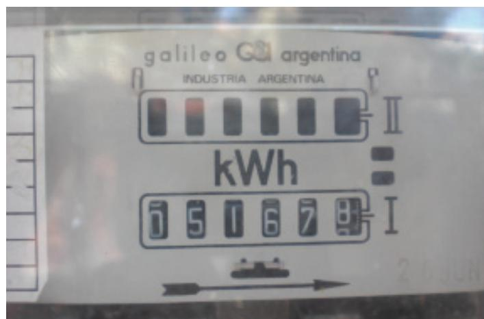
Medidor con doble numerador tal como se lo usa actualmente con su segundo numerador cegado.
