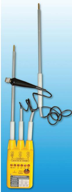
verificar. Asimismo, tampoco posee llaves ni ningún otro elemento mecánico de conmutación, ni componentes activos para producir la indicación lumínica. Dado que no cuenta con componentes activos, el indicador de secuencia consiste básicamente en un circuito desfasador compuesto por resistencias y capacitores, insensible a picos de tensión.
