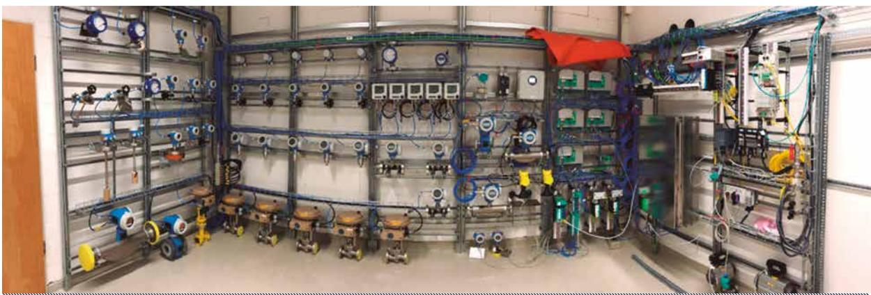
Figura 14. Prueba de interoperabilidad de Ethernet APL
