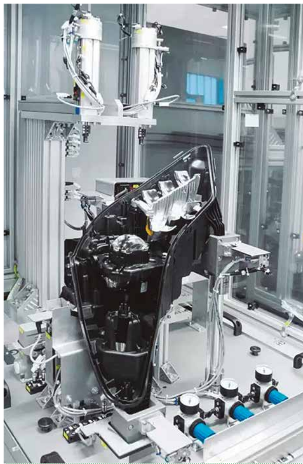
Las unidades lineales y giratorias DSL tiran del módulo de la luz para comprobar su asiento correcto.
