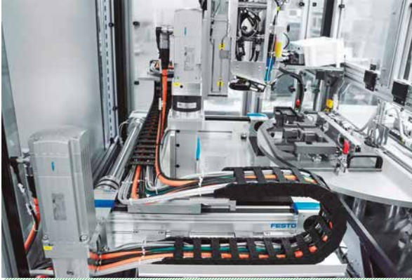
El sistema de manipulación suministrado listo para instalar se encarga de la aplicación homogénea de una pasta bicomponente.
