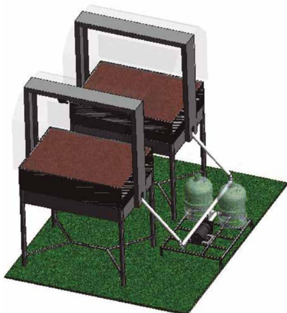
Figura 2. Esquema estructural del sistema de propagación de olivo
