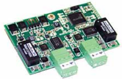
Tarjeta de salida de dos canales TIENet 308, 4-20 mA: dos salidas escalables separadas; acepta hasta tres tarjetas por separado, para seis canales de salida simultáneos; posibilidad de tarjetas adicionales cuando se instala en una caja de expansión.
