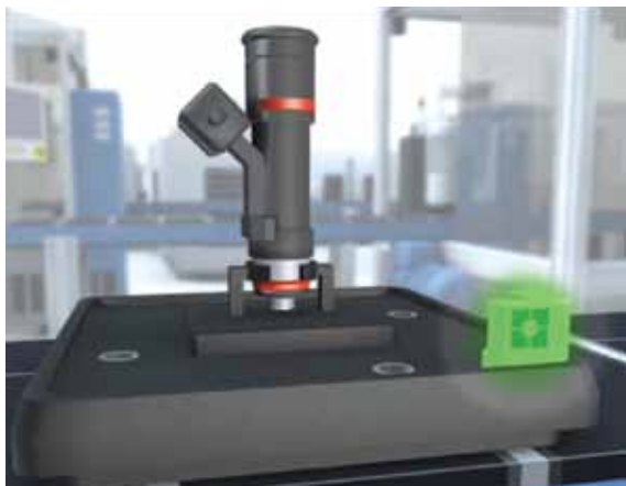
Cuando se utiliza un pallet, se colocan etiquetas RFID permanentemente sobre el pallet para permitir la trazabilidad
