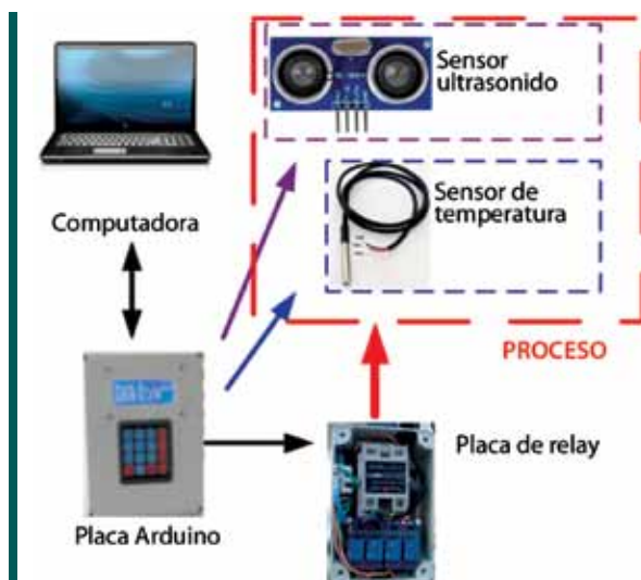
Figura 1. Esquema de comunicación entre los dispositivos del sistema
