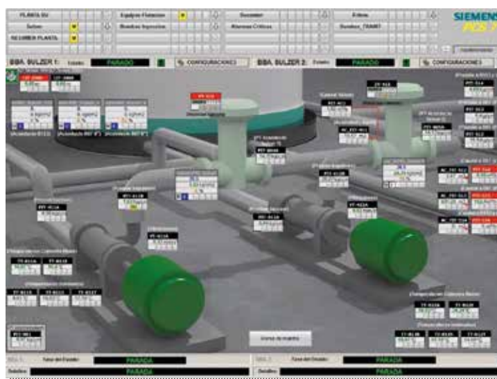
Pantalla SCADA del Sistema de transferencia
