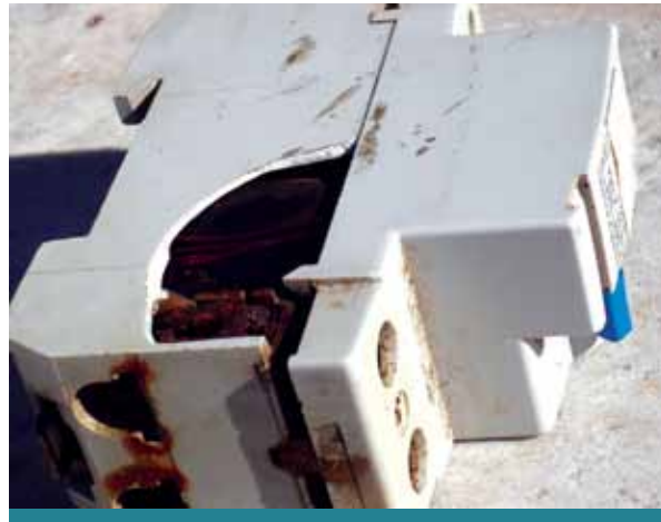
Sobrecarga y/o contacto flojo
