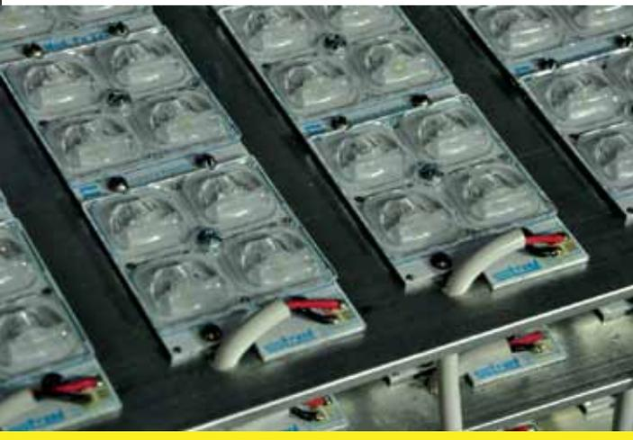
Plaquetas o módulos de leds FX220
