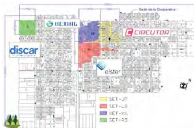
Figura 2: cuatro centros de transformación MT/BT, en donde se reemplazarán los medidores de los clientes por equipos inteligentes e integrados a redes de telecomunicación.
