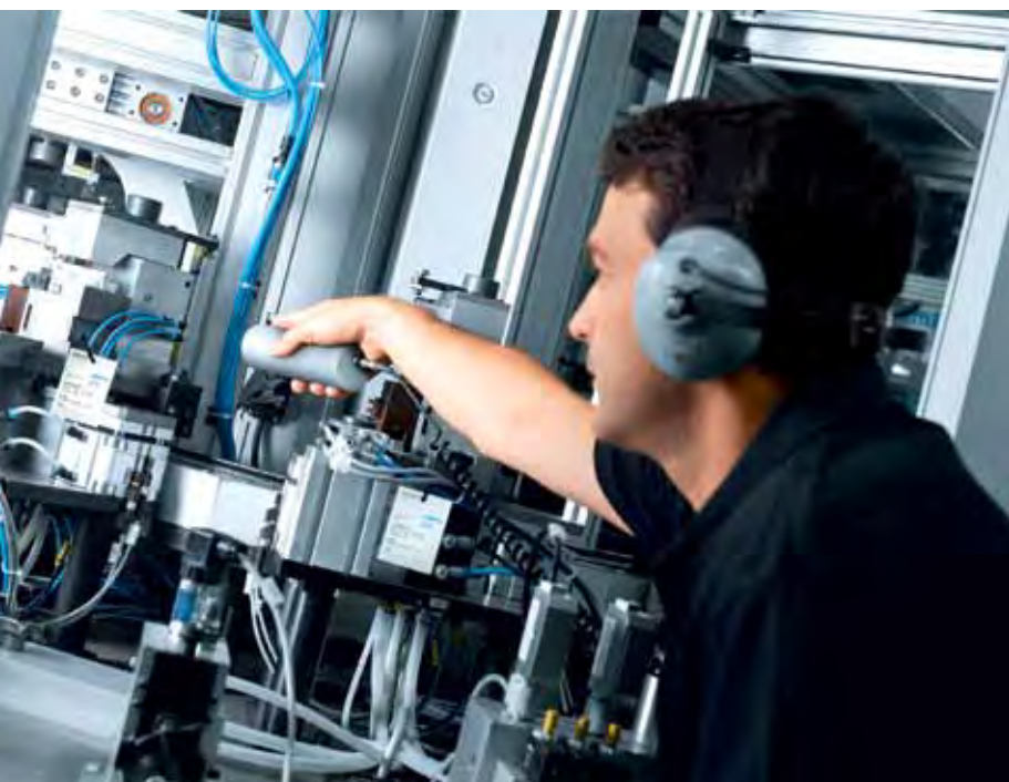
Localización de fugas con detector de ultrasonidos: mantener bajo control el consumo de energía en la planta con el servicio de ahorro de energía de Festo
