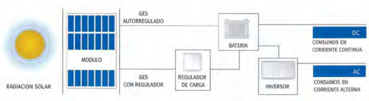
Configuración de los Generadores Eléctricos Solares (GES)
